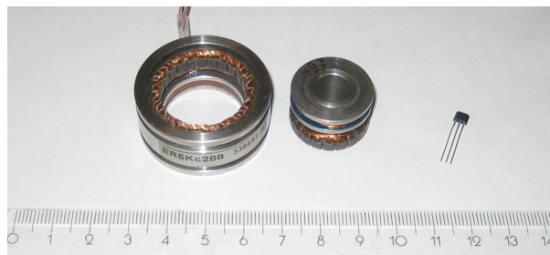
Figur 2: Resolvern med urplockad rotordel och den lilla hallsensorn.
